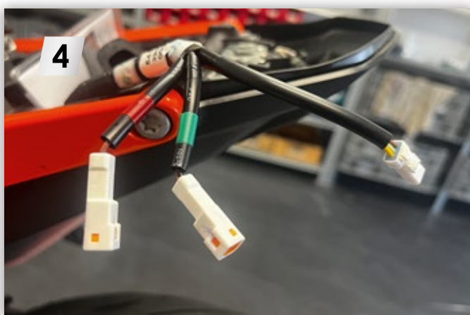
Originales Blinker- und Trägerkabel wieder verwenden Reuse original turn signal and holder cable
