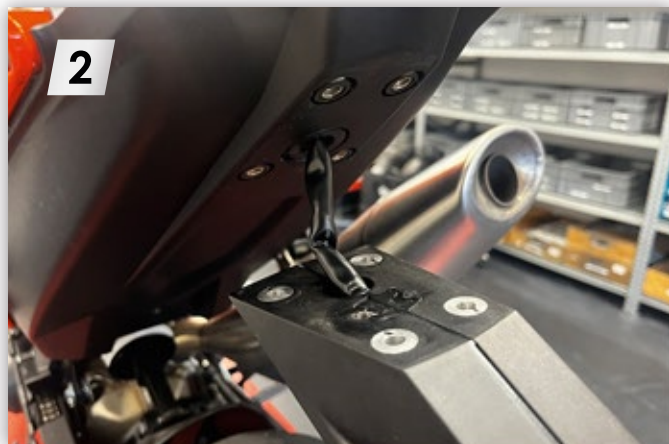
Kennzeichenträger demontieren Disassemble license plate holder
