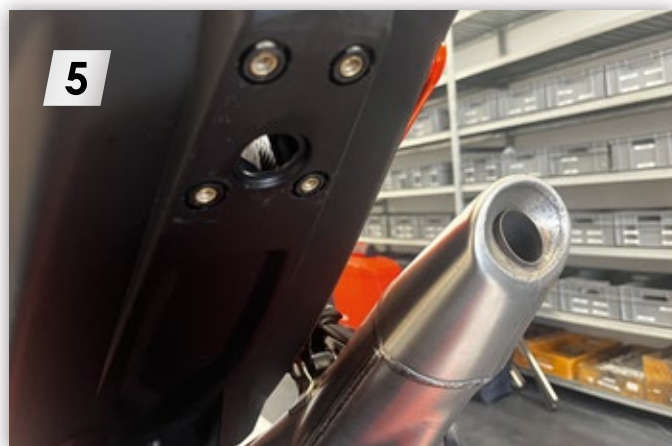
MIZU FLY-Design Kennzeichenträger montieren Mount MIZU FLY design license plate holder
