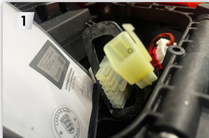
Hauptstecker lösen Disconnect main plug
